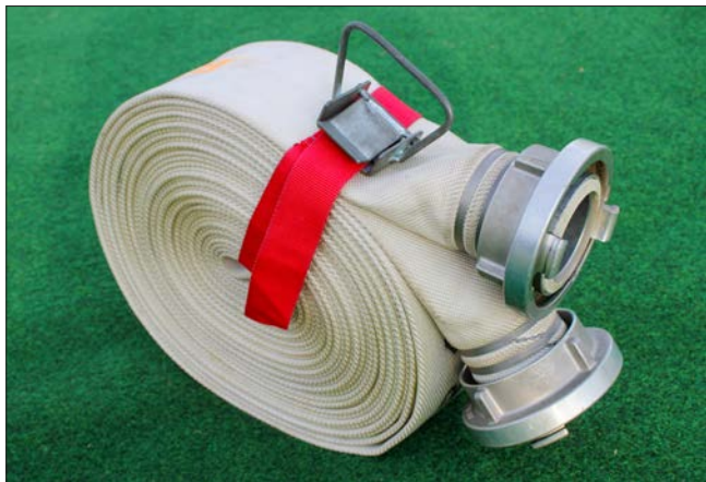
Abb. 2: Doppelt gerollter Druckschlauch (BFKDO Oberwart)
